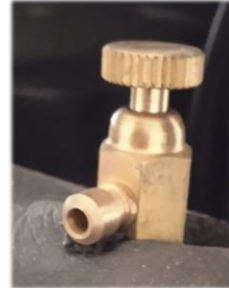
Εικόνα 2. Ενσωματωμένη βαλβίδα εξαερισμού
